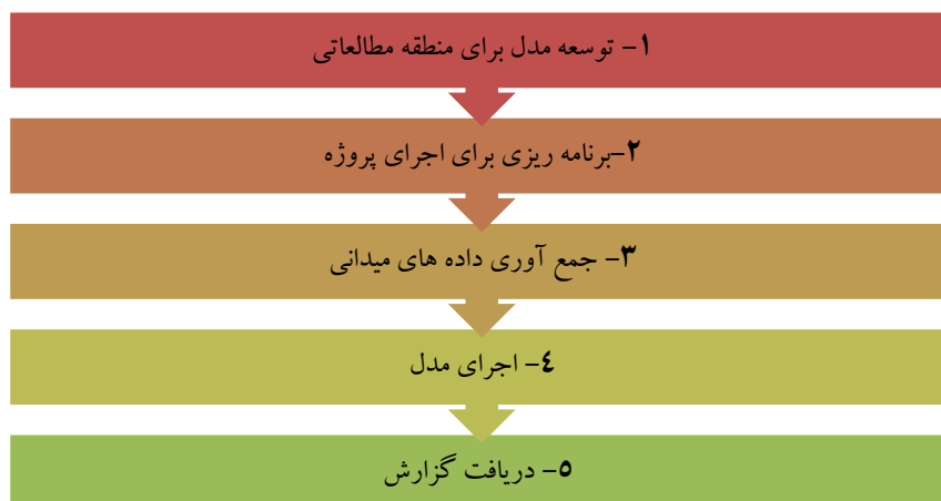
شکل ۲ مراحل پنجگانه اجرای مدل i-Tree Eco جهت کمی‌سازی خدمات اکوسیستمی در خارج از مرزهای ایالات متحده (منبع: i-Tree Eco User's Manual, 2019)
